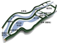
最下流の調節池排水門は開いており、貯水「彩湖」の水位調節は、水位調節堰で行います。鴨川の荒川への合流は、昭和水門、さくらそう水門を開いておくことにより行います。
