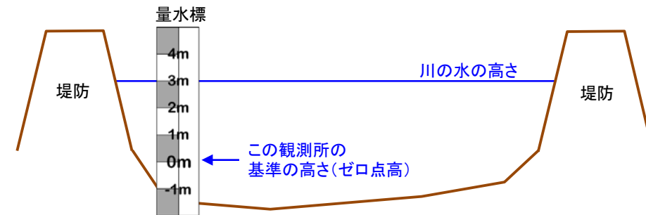
水位計測のイメージ この場合の水位は+3.0m
