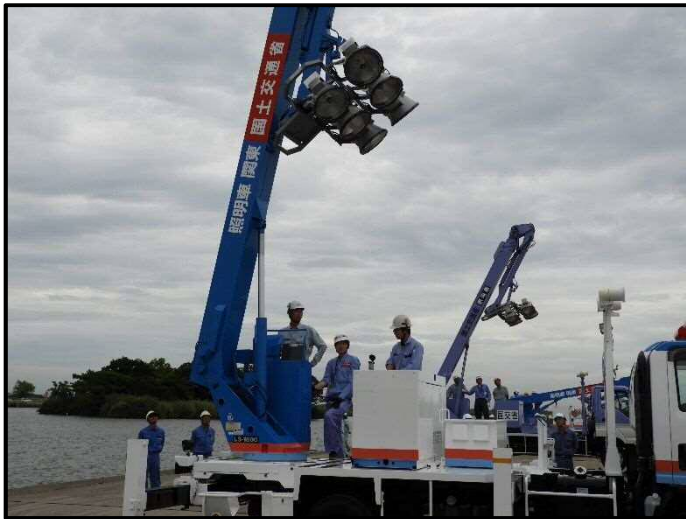
・照明車 災害現場、作業現場内の照明作業、排水ポンプ等の電源供給及び非常用電源として使用します。本講習においては、照明車の準備から実際の操作まで一連の作業を行いました。
