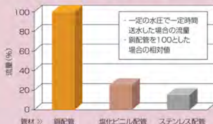
グラフ 2 各管材における送水実験終了時の流速
