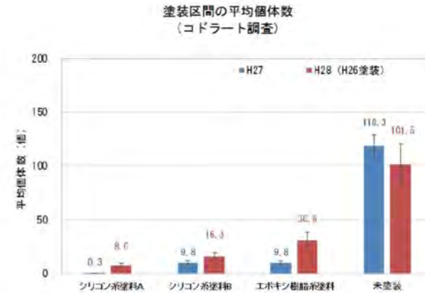
図 41 塗装区間における水路壁面への固着個体数
