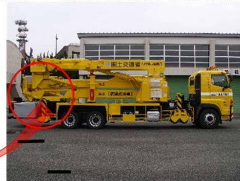
既存の橋梁点検車のバスケットに上下伸縮式作業台(アタッチメント)の取付けできるよう開発
