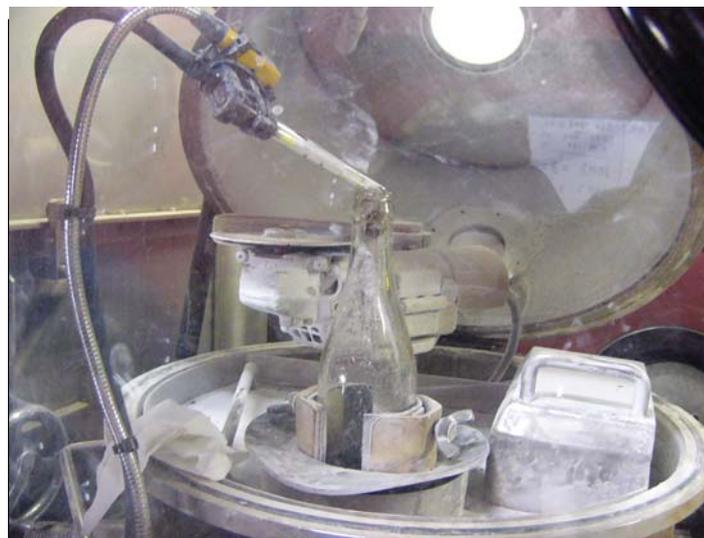
02 開栓後、検知管による同定
