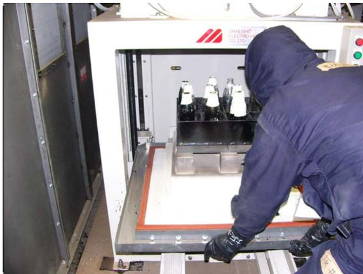
03 電気炉による燃焼
