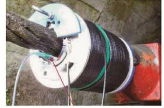
写真-3 全磁束法による腐食状況調査
