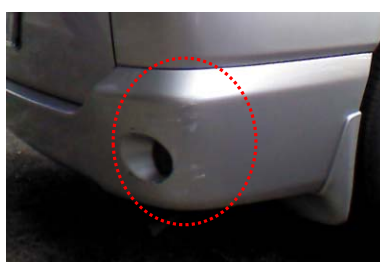
リアバンパー右側を損傷
