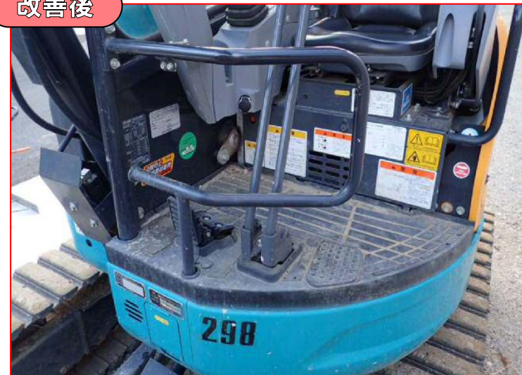
運転席内の整理・整頓をオペレーターに注意喚起し、置かれていた工具も直ちに撤去
