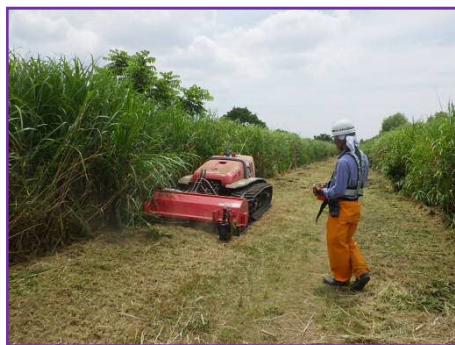
リモコンによる大型遠隔式除草機械の操作
