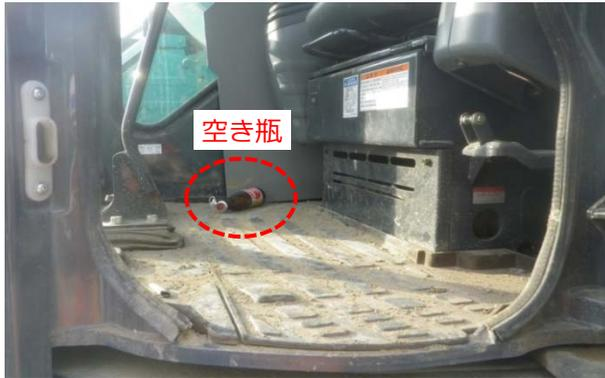
バックホウの運転席に空き瓶が転がっており、オペレーターの転倒や誤操作が誘発される危険がある
