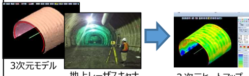
3次元モデルと3次元計測を連携することで、施工エリアの面的管理を実現、施工の実施状況の把握及び出来形管理の効率化を図る
