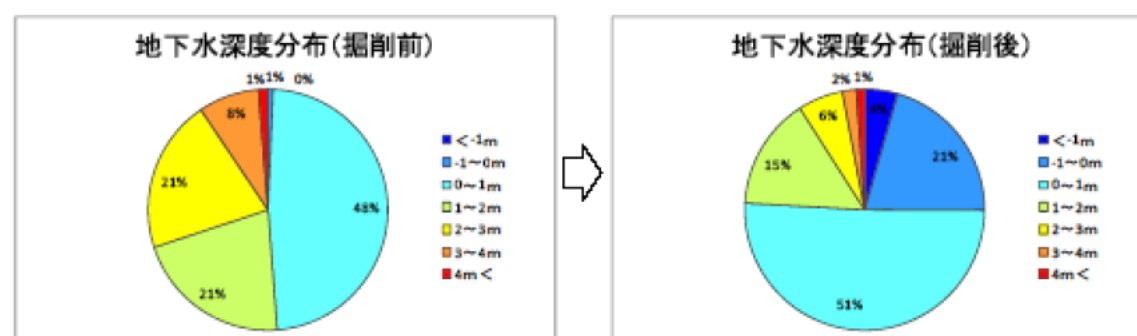
図3-7 地下水位分布の面積比変化
