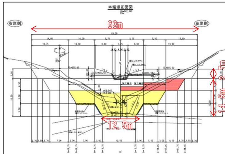
砂防堰堤正面図
