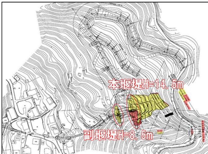
砂防堰堤平面位置図
