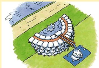
土のうを半月型に積み、鉄の杭などを刺し補強します。その中に水をため、その水圧で水が漏れることを防ぎます。堤防に近い場所での漏水に用います。
