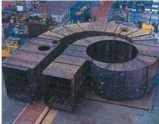
写真5 ダブルボリュートのポンプケーシングの例
