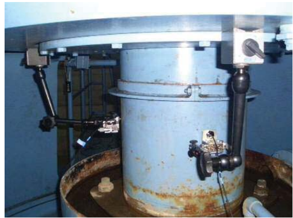
写真2 渦電流式変位計(設置角90°)
