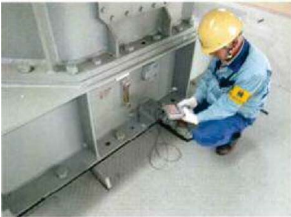
写真1 振動加速度計による計測方法
