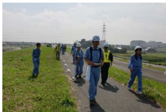
牽引式電気探査の研修状況
