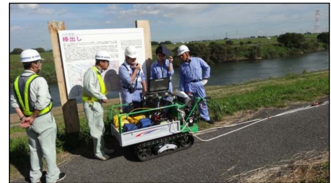
クローラー型運搬車による牽引の例 (関東技術事務所で所有)
