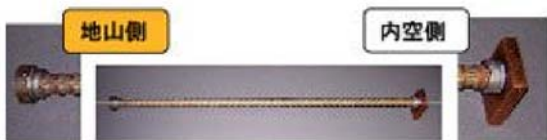
ポスト・ヘッド・バーと摩擦圧接部
