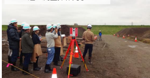
3Dレーザースキャナー・UAVによる 起工測量操作見学
