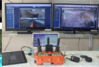
オペレーターは、前方2台・後方1台の3台のカメラにより周囲の状況を確認しバックホウを遠隔操作します。
