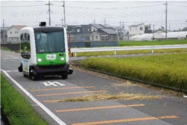
路面上の落下物への対応 （麦わら、水たまり、泥等を使用）
