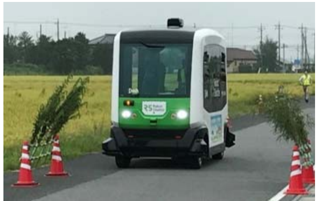
道路上の障害物への対応 （駐車車両や繁茂した雑草に見立てた障害物を使用）
