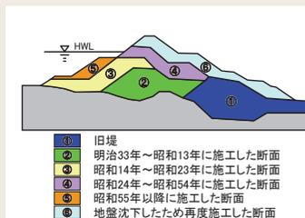
▲利根川右岸139km付近の築堤履歴図
