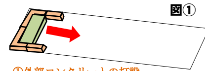
①外部コンクリートの打設
