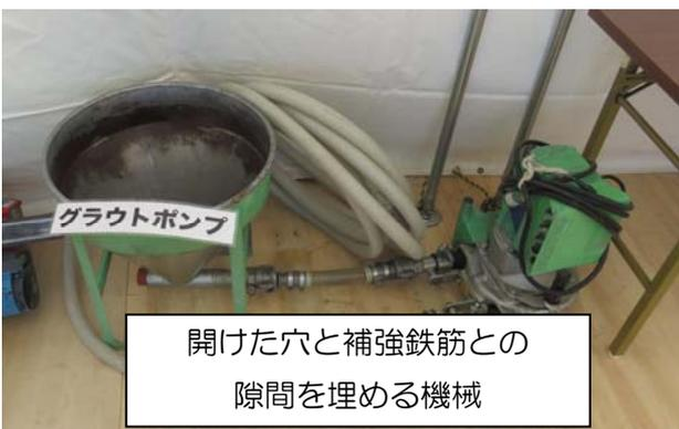
開けた穴と補強鉄筋との隙間を埋める機械
