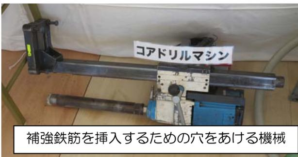
補強鉄筋を挿入するための穴をあける機械
