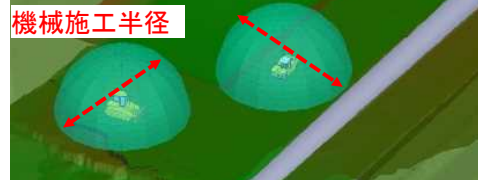
施工シミュレーションによる安全計画立案
