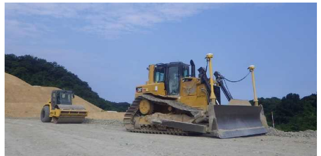
地元企業等が連携。後付け機器でICT施工を実施 ICT建機は3次元施工データを共通化
