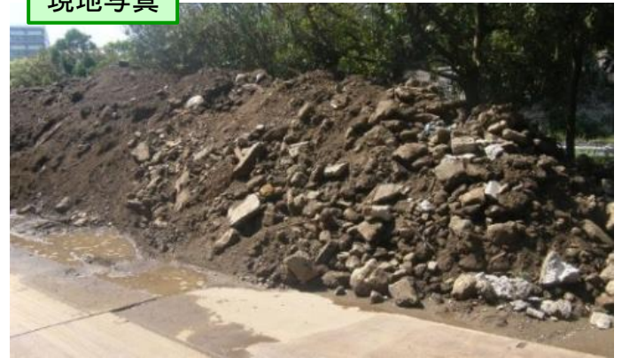
ガラ混じりの建設発生土
