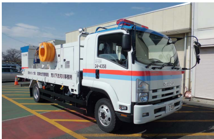
排水ポンプ車
