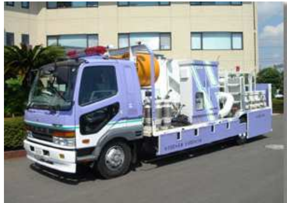
排水ポンプ車
