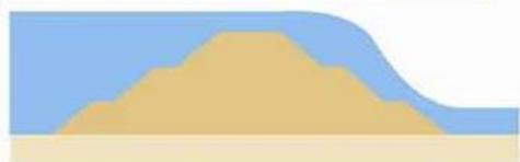
越流水により土で出来た川裏法尻を洗掘される
