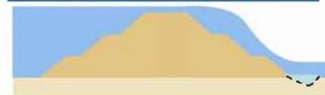
堤防の法尻が洗掘され、堤防が崩壊
