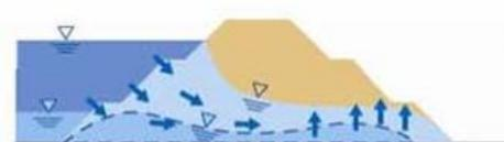
堤防の中の水位がさらに上がり、堤防が弱くなって崩壊しやすくなる
