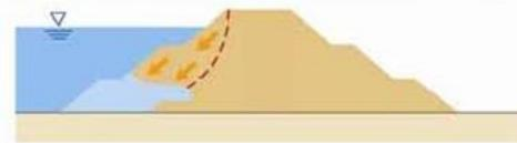
堤防の法尻が洗掘され、堤防が崩壊
