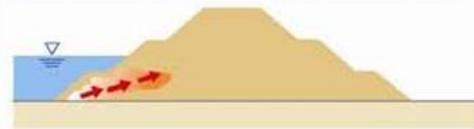
さらに侵食・洗掘が進むと堤防がすべり始める
