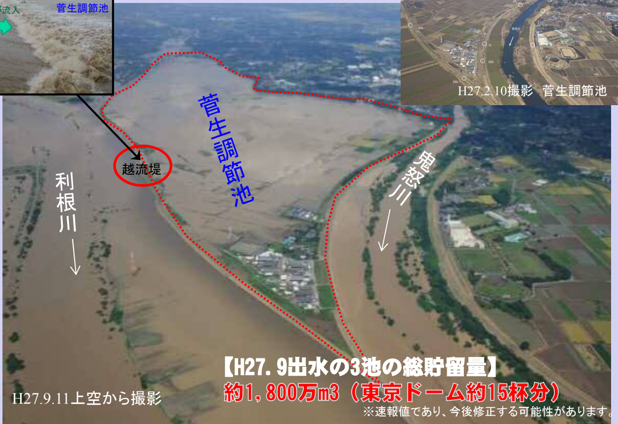
◀利根川の水が越流堤を超えて菅生調節池に流入している状況
