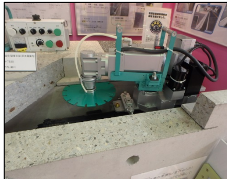
側溝補修技術
