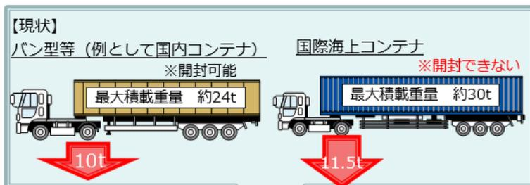
【緩和後】国際海上コンテナ輸送車両に限らず駆動軸重11.5tに緩和
