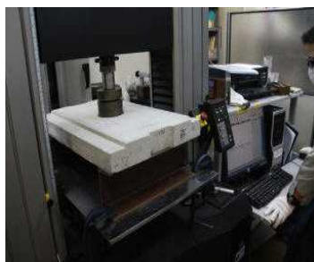
写真-3 基本性能確認押抜試験
