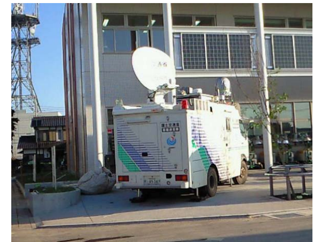
衛星通信車での通信回線の確保
