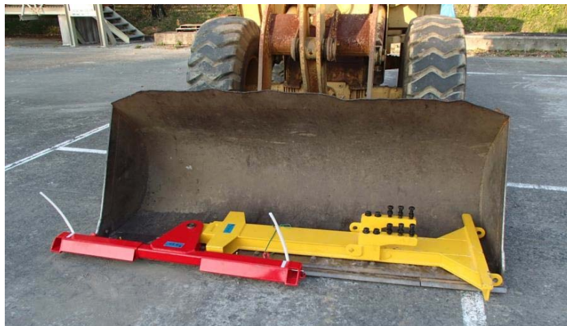
連結時先端の一部がはみ出し
