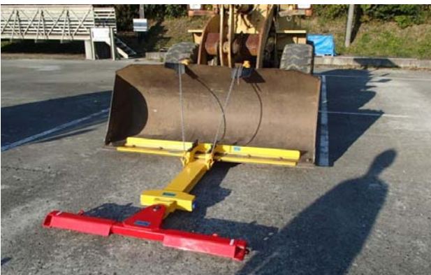
⑨牽引装置取付完了
