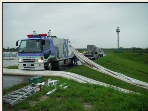
▲災害時の排水ポンプ車出動状況
