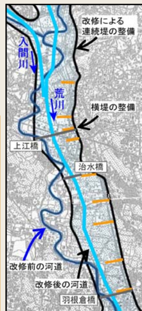
▲横堤整備と河道直線化
