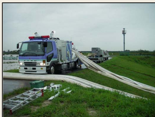
▲災害時の排水ポンプ車出動状況
