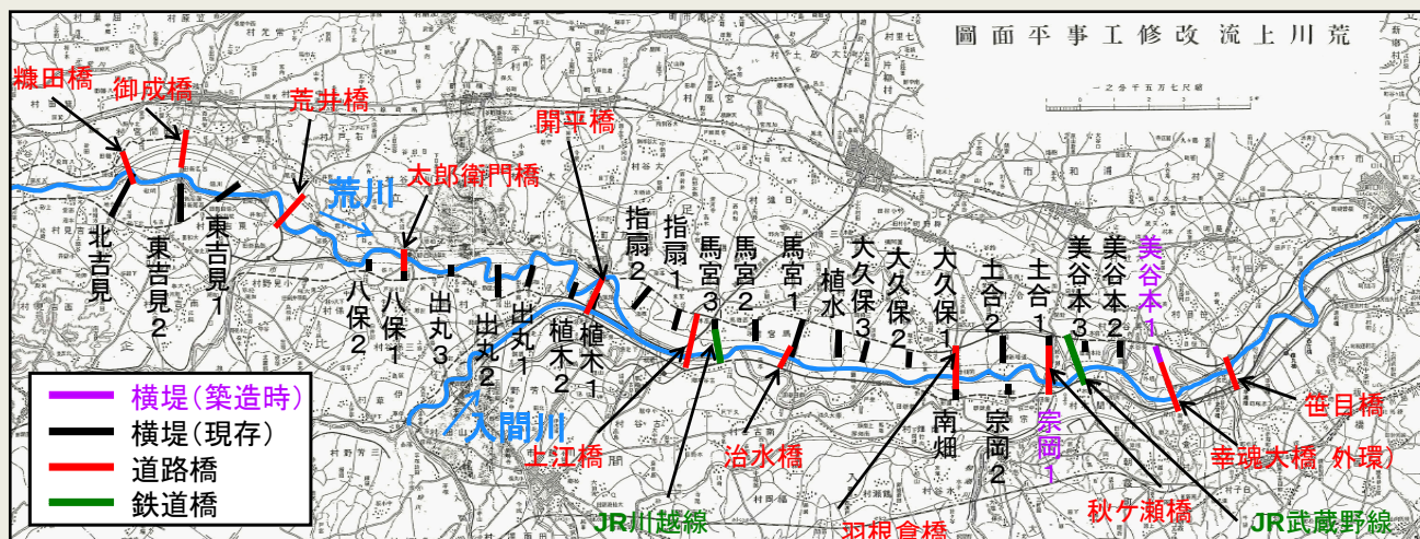
▲現在の荒川横堤と橋梁
