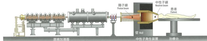
直線型加速器で加速された陽子線が、中性子発生装置内のベリリウムと反応して中性子を病巣部に照射することにより、がんの治療を行う。
