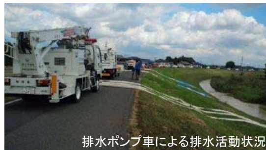
排水ポンプ車による排水活動状況
