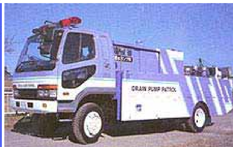
被害軽減対策 (排水ポンプ車)
