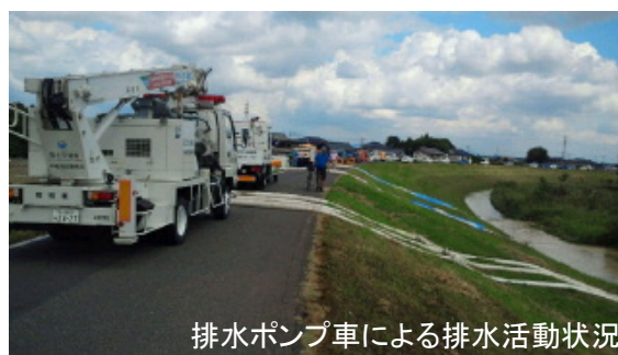
排水ポンプ車による排水活動状況
