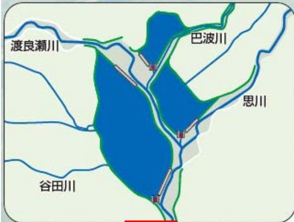
2 洪水時には越流堤より遊水地内へ水が流れ込み下流に流れる水の量を減らす
