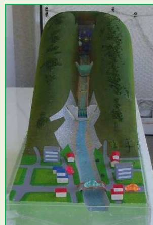
【土石流実験模型】 ビー玉を土石流に見立て、砂防堰堤の効果を実験
