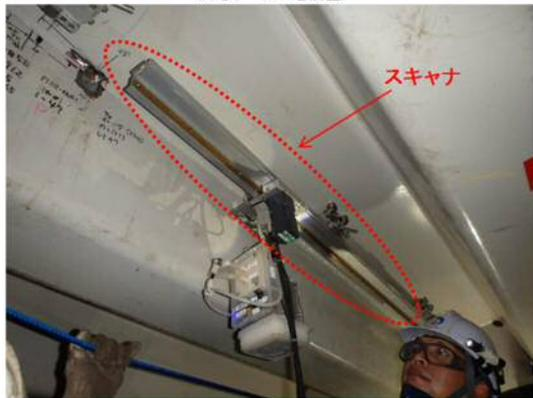
磁石によりデッキ下面にスキャナと探触子を設置し、自動探傷を実施
