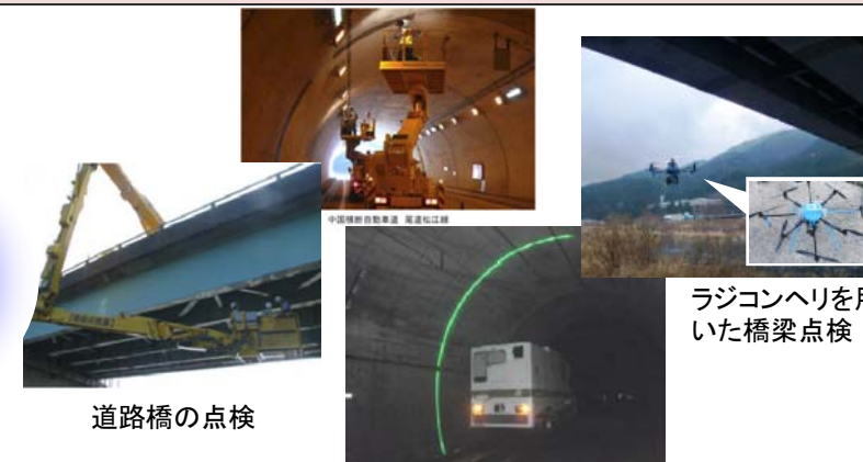
レーザーを用いた 覆工ひび割れ点検
