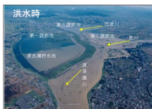
洪水時に遊水地内へ最大約1.7億m 3 を貯留し、下流に流れる水量を低減
