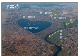
洪水時に遊水地内へ最大約1.7億m 3 を貯留し、下流に流れる水量を低減
