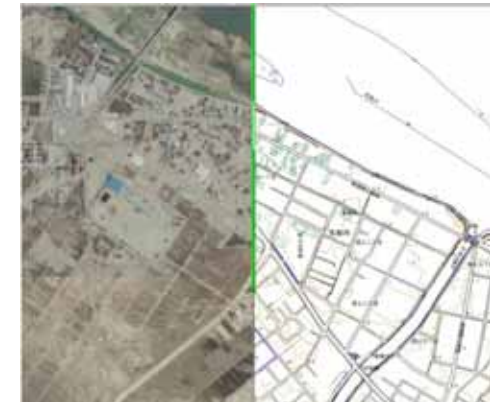
震災後の空中写真により 災害復興計画基図を作成
