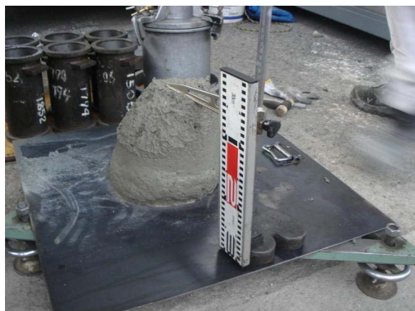
（スランプ試験：硬さの確認）
