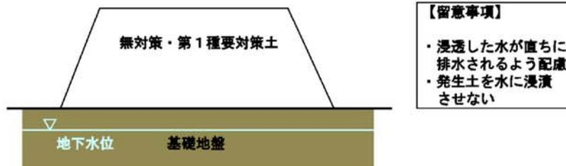
図 5.3.1 平場施工時の概念図
