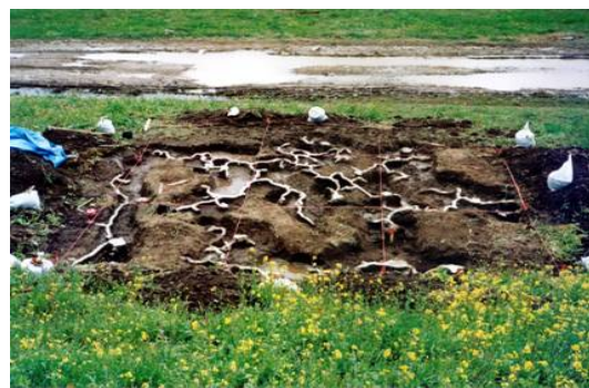
図 2.4 調査により可視化された モグラ穴の実態（石膏部分）
